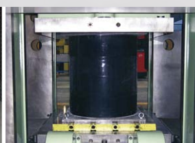
Belastungsversuch von hiDCon-Fundationselementen
