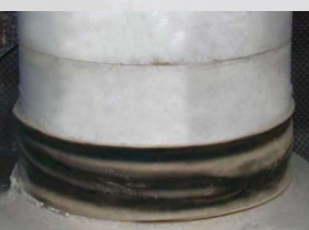
Belastungsversuch von hiDCon-Fundationselementen
