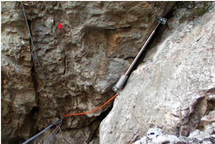
Überwachung Felsmassiv während Sprengvortrieb für den neuen La Roche Tunnel.
