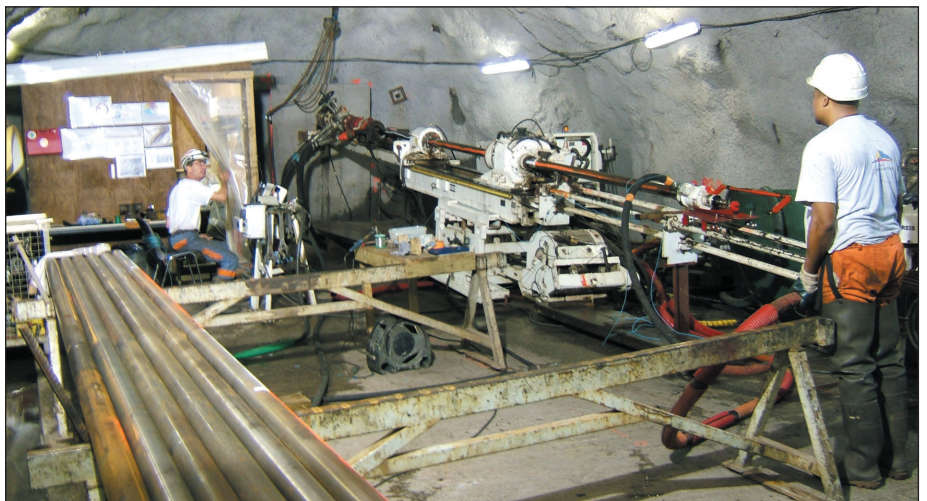
Photo 3 - Foreuse COFOR (COREIS) sur forage SLP2
