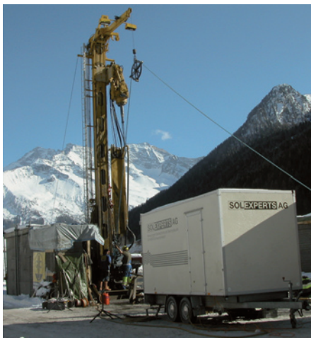
Hydrogeologische Bohrlochversuche mit dem von Solexperts entwickelten Doppel-Packersystem.
