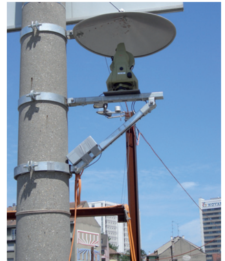
Geomonitoring beim Tunnel Luzernerring: Motorisierter Tachymeter zur Überwachung und Aufnahme verschiedener Messpunkte.
