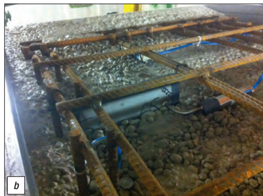
Figure 5 - (a) schéma de l'instrumentation en forage mise en place avant le creusement de la galerie GCS pour suivre les déformations et les variations de pression interstitielle en champ proche et lointain - (b) photographie du coulage des voussoirs instrumentés par des cordes vibrantes et des cellules de pression totale / (a) diagram of borehole instrumentation used prior to excavation of the GCS gallery to monitor deformation and adjacent and distant pore pressure variations - (b) photograph taken during pouring of the arch segments fitted with vibrating wire strain gauges and total pressure gauges.
